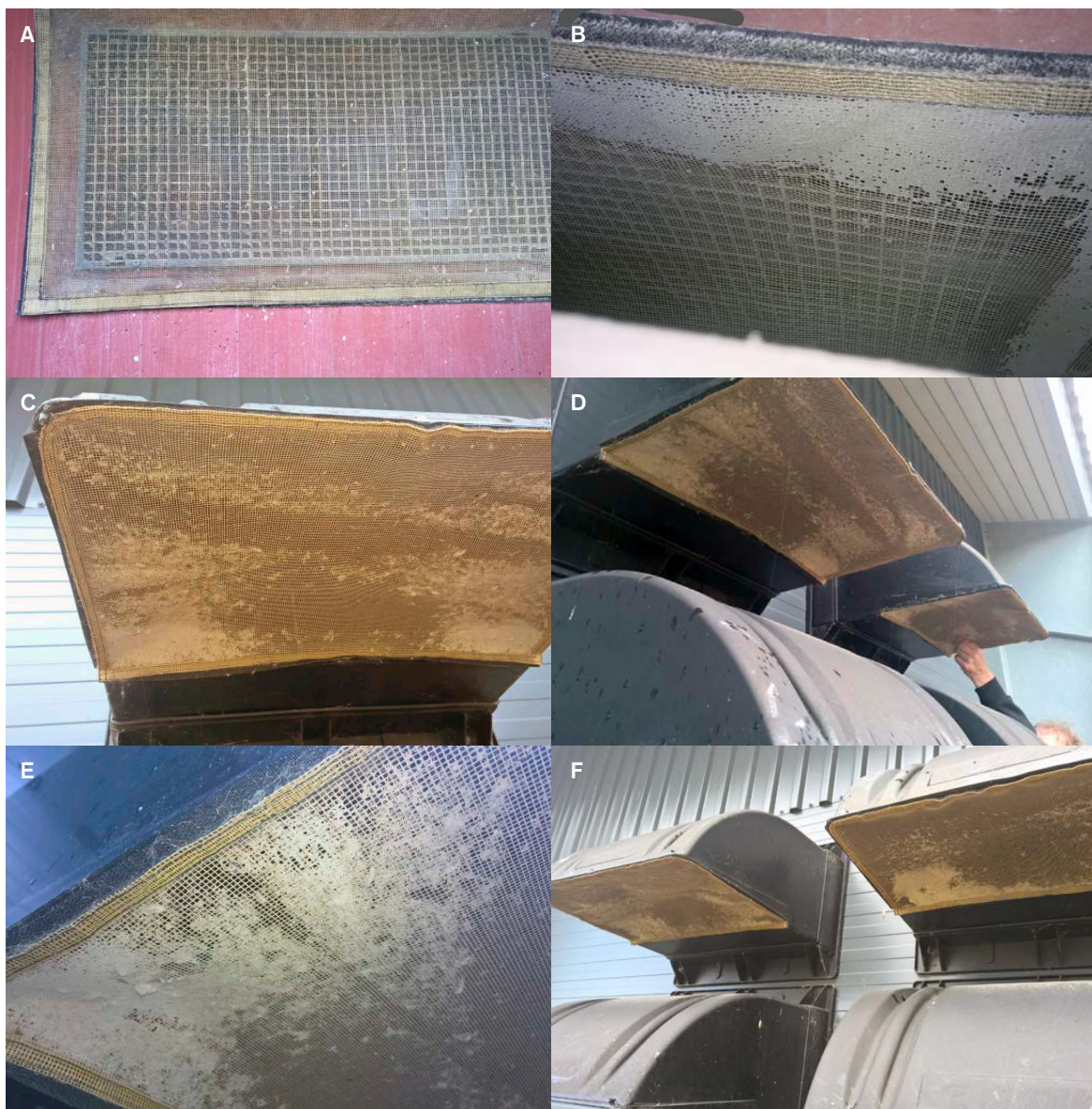
Figur 11. Prototype 2 (A og B) og prototype 3 (C-F) tilstoppet med støv og frø – og der i nogle tilfælde dannede "kager", der var svære at fjerne.
