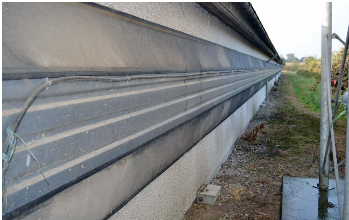
Figur 10. Prototype 1 tilstøvet på net-areal udenfor ventilerne – og mellem ventilerne er der ikke tilstøvet i nævneværdig grad.
