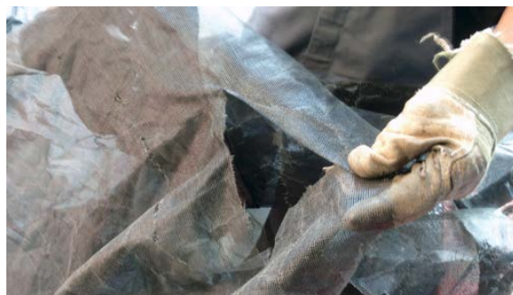
Figur 9. Et Delcotex-Kevlar skorstensnet med revner pga. vindbelastning forsommer 2016.
